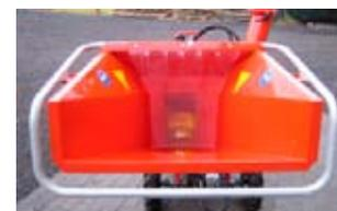
La barre de contrôle qui entoure la trémie d'alimentation permet depuis le poste de travail de modifier à la fois la vitesse et le sens de rotation du rouleau ameneur. Il en résulte une prise en main intuitive, quasi immédiate du contrôle du broyeur.
